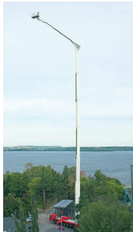
Imagen 5. La F 101 HLA tiene un alcance horizontal de trabajo de 28 metros.
