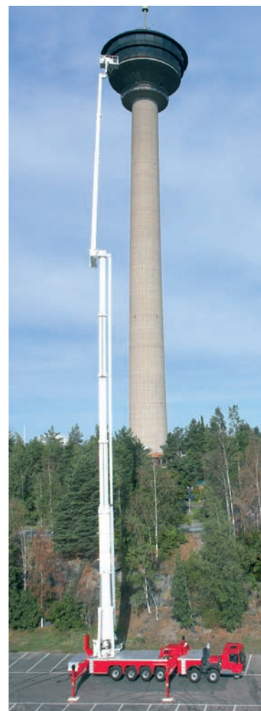
Imagen 2. Su altura máxima de trabajo es de 101 metros.
