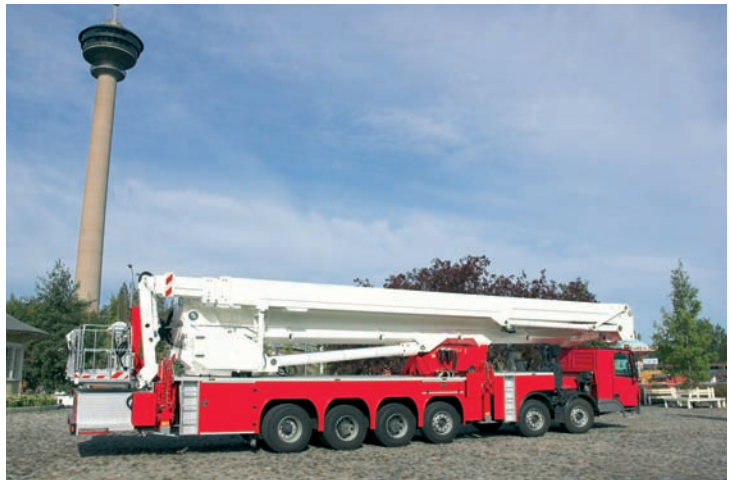
Imagen 3. La primera unidad de 101 m ha sido fabricada para la compañía belga Maes. Se instaló sobre un chasis Mercedes Benz 6258 Actros 12x4.
